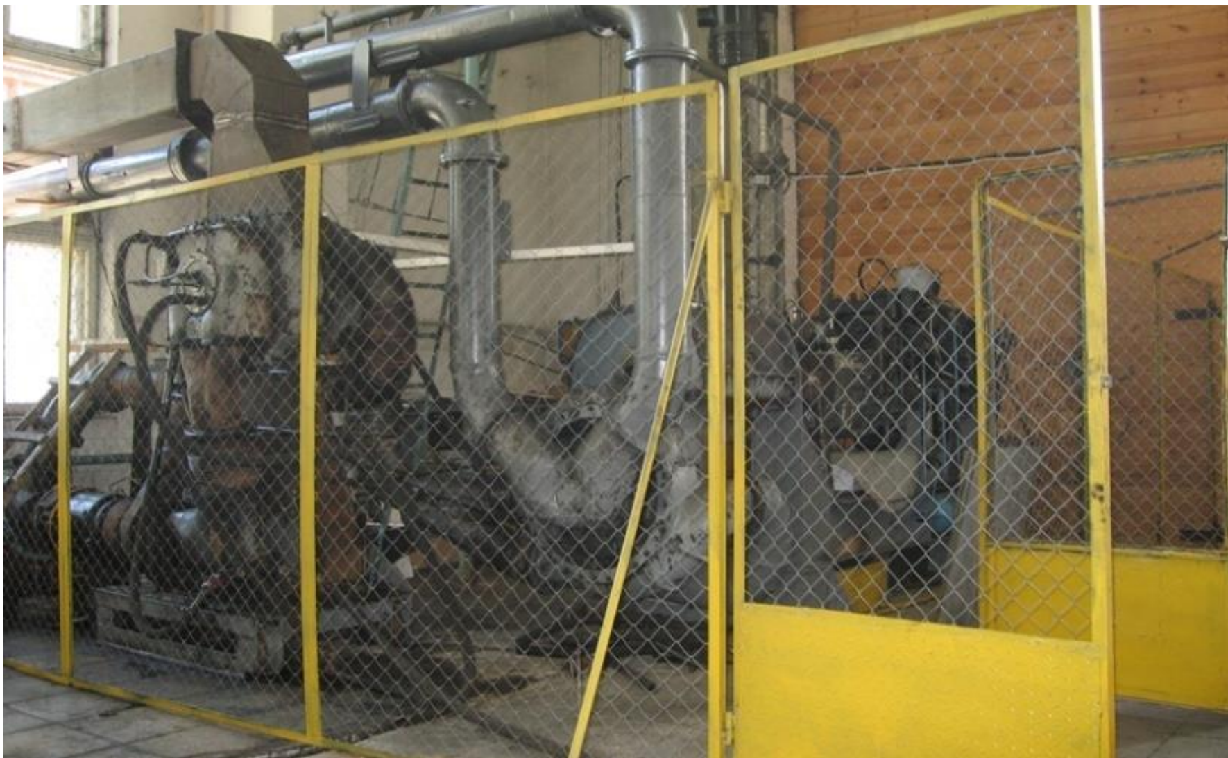
Рис.3 Стенд для испытания турбокомпрессора ТК-34
